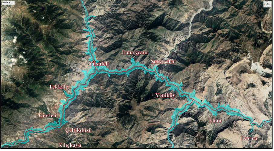
Şekil 1. Yusufeli Barajı ve HES Projesi rezervuar alanı (Google Earth, 2019, Çoruh Nehrinin baraj sınırları içerisindeki mevcut su yüzeyi (yaklaşık 2,23 km 2 ) miktarı Google Earth Programında 2019 Yılı Aralık ayında görülen uydu görüntüsü üzerinden ölçümler modülü yardımıyla hesaplanmıştır.)
