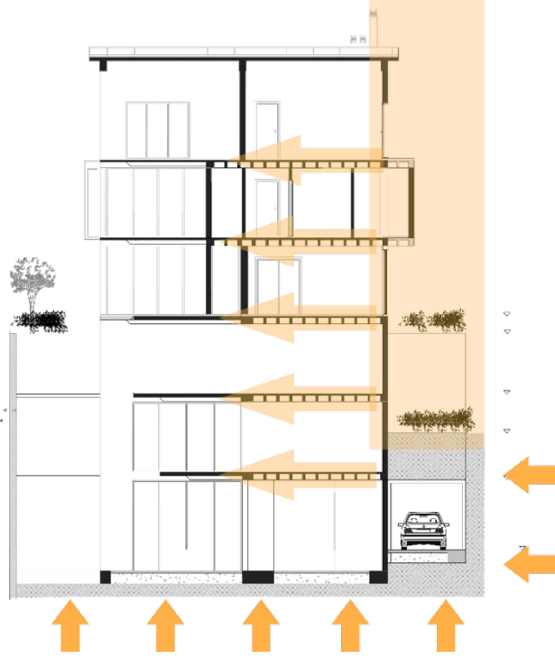
Şekil 14. Binanın Enine Kesiti ve Isı İletimi
