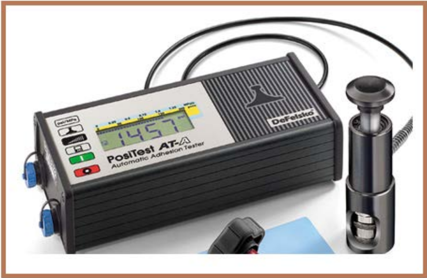
Şekil 2. Adhezyon Pull-off test cihazı
