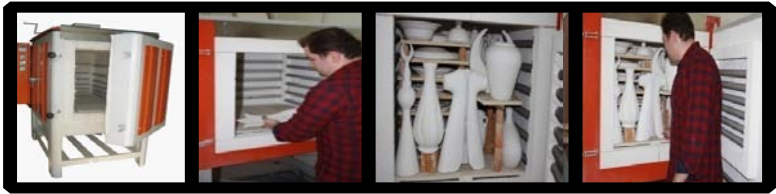
Şekil 3.9. Elektrikli kamara fırınlar ve pişirim
