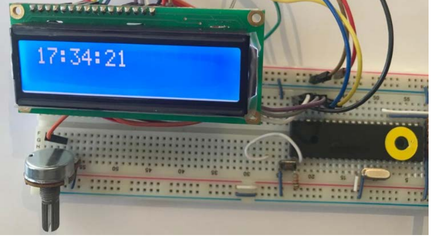
Şekil 9.5. LCD üzerinde dijital saat gösterimi
