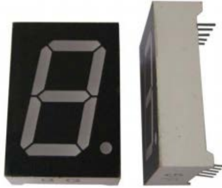
Şekil 7.1. Seven segment gösterge elemanı
