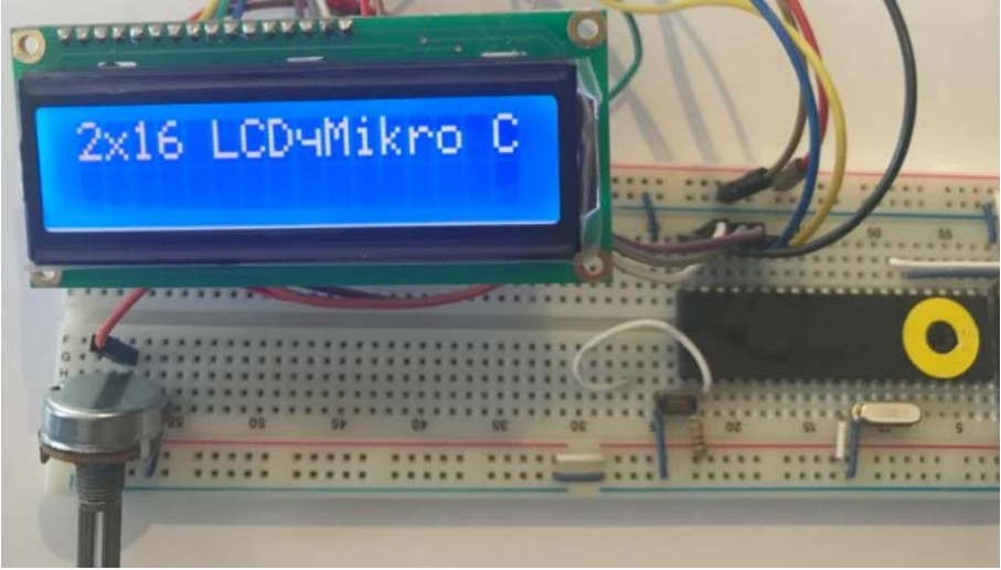
Şekil 9.4 2x16 LCD MikroC yazımın gösterimi
