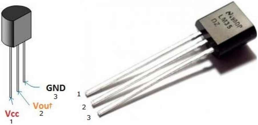
Şekil 8.5. LM35 Sıcaklık Sensörü bağlantısı
